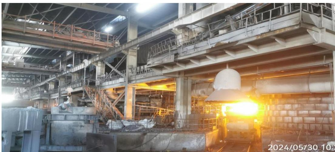
工业硅出炉浇筑铸锭
