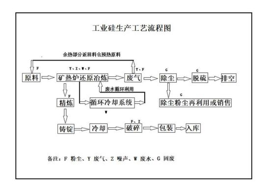
生产工艺流程说明:金属硅生产是将硅石及碳质还原剂按一定配比,混合后作为炉料加入矿热硅电炉中进行冶练的过程,在硅炉电弧热的高温条件下通过还原反应而得到金属硅。还原反应的过程比较复杂,其总反应式可表达为:
