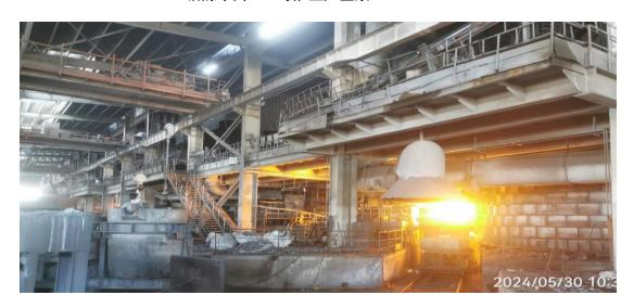
工业硅出炉浇筑铸锭
